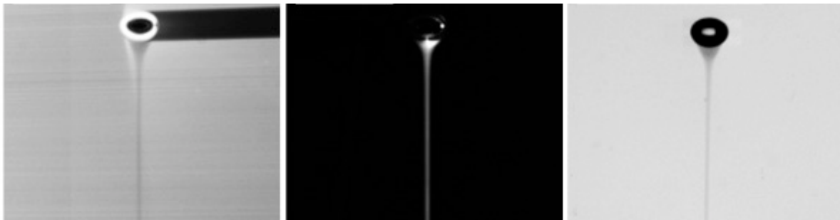
Figure 95. Visualisation du transfert de matière autour d'une bulle millimétrique en ascension dans un de l'eau au repos. De gauche à droite : par PLIF, par fluorescence laser en présence de résazurine, par colorimétrie et éclairage arrière.
