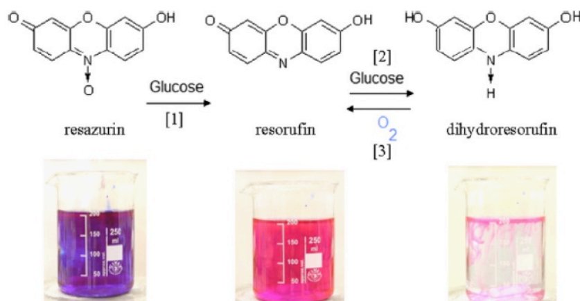
Figure 29. Réaction entre l'oxygène et la dihydroresorufine (équation [3]) permettant de visualiser le transfert d'oxygène. Extrait de (Dietrich et al., 2013).
