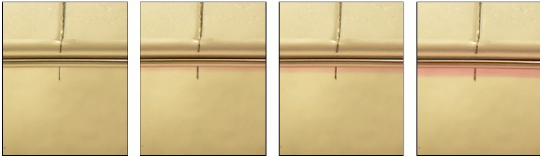
Figure 50. Visualisation de la diffusion de l'oxygène par colorimétrie en présence d'une sonde à oxygène de 25 \mu\text{m} insérée verticalement au niveau de l'interface.
