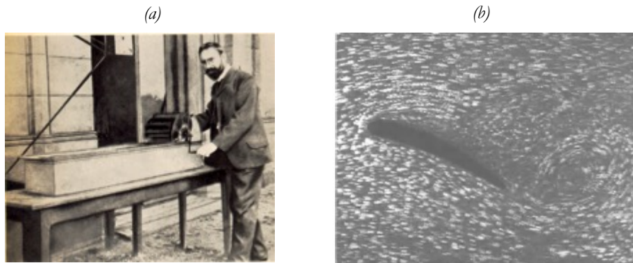
Figure 10. (a) Photographie de Prandtl en train d'utiliser son canal hydraulique de visualisation où il fit de nombreuses découvertes en 1904, extrait de (Darrigol, 2005). (b) Photographie de l'écoulement visualisé par Prandtl autour d'un obstacle, extrait du film : Historische Filmaufnahmen Entstehung von Wirbeln bei Wasserströmungen (DVD) IWF Wissen und Media gGmbH.
