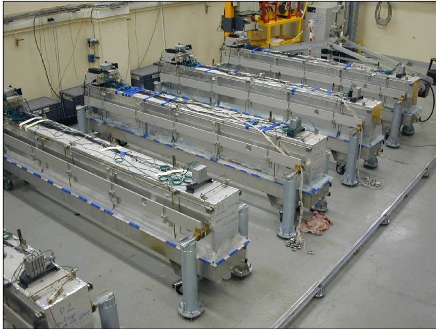
Figure 27 : Campagne expérimentale sur poutres de laboratoire (LCPC / EDF) (Multon, 2004)
