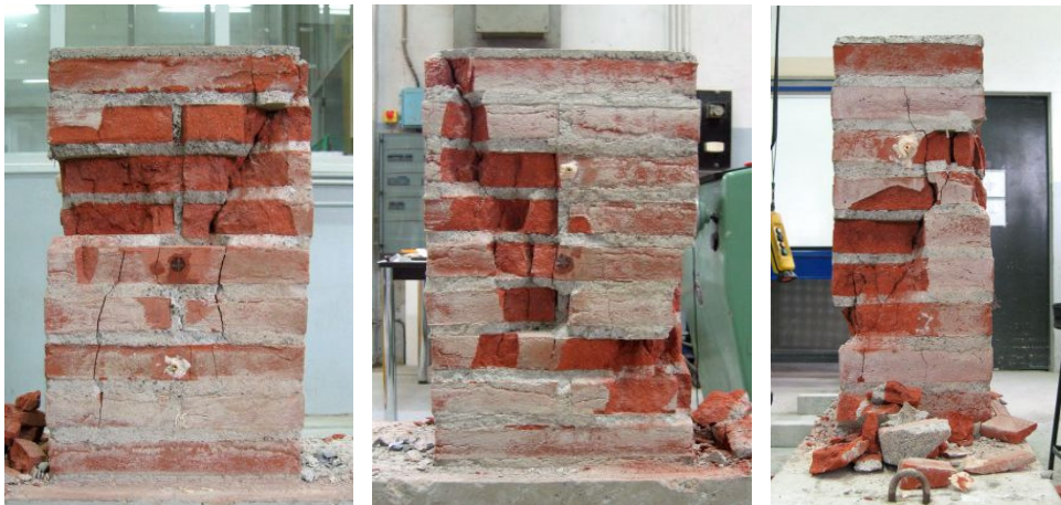
Figure 53 - Essais sur muret. Photos après rupture.
