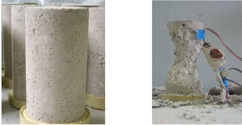
Figure 38 - Eprouvettes cylindriques 6 \times 12 de mortier de chaux, surfacées au soufre, avant et après essai.
