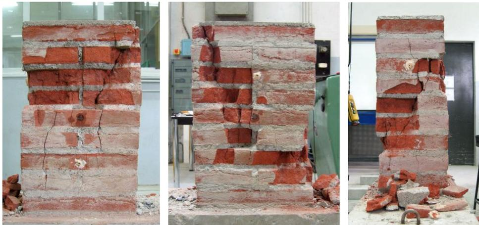
Figure 53 - Essais sur muret. Photos après rupture.
