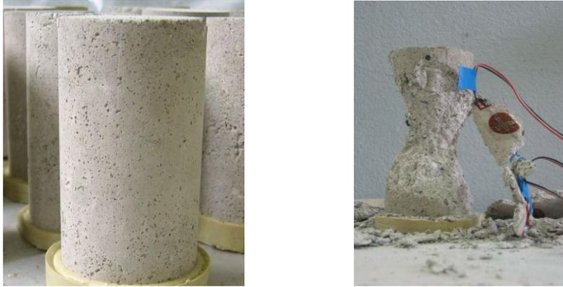
Figure 38 - Eprouvettes cylindriques 6 \* 12 de mortier de chaux, surfacées au soufre, avant et après essai.
