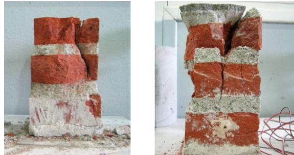
Figure 49 - Essais sur sandwiches. Photos après rupture.
