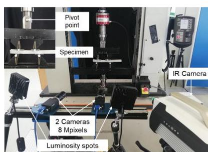
Fig. 2. Essai 4ENF
