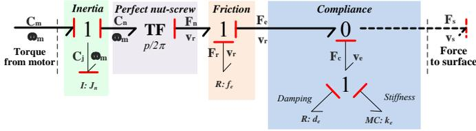
FIGURE 7. BASIC MODEL OF MPT IN BOND-GRAPH.
