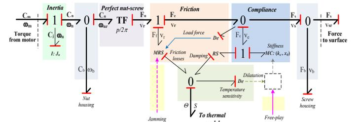
FIGURE 10. FULL MODEL OF MPT IN BOND-GRAPH.
