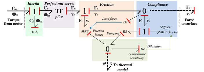
FIGURE 8. ADVANCED MODEL OF MPT IN BOND-GRAPH.
