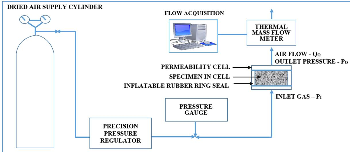
**Fig. 1: Experimental apparatus**
