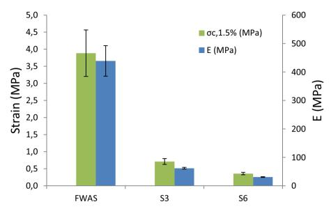
Fig. 4. Compressive strength at 1.5% strain ( $\sigma$ c,1.5%) and Young's modulus with friction at the plate- specimen interface Fig. 4. Résistance en compression pour 1,5% de déformation ( $\sigma$ c, 1,5%) et module d'Young (essai avec frettage).
