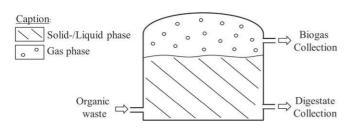
Fig. 1. Anaerobic digester scheme.
