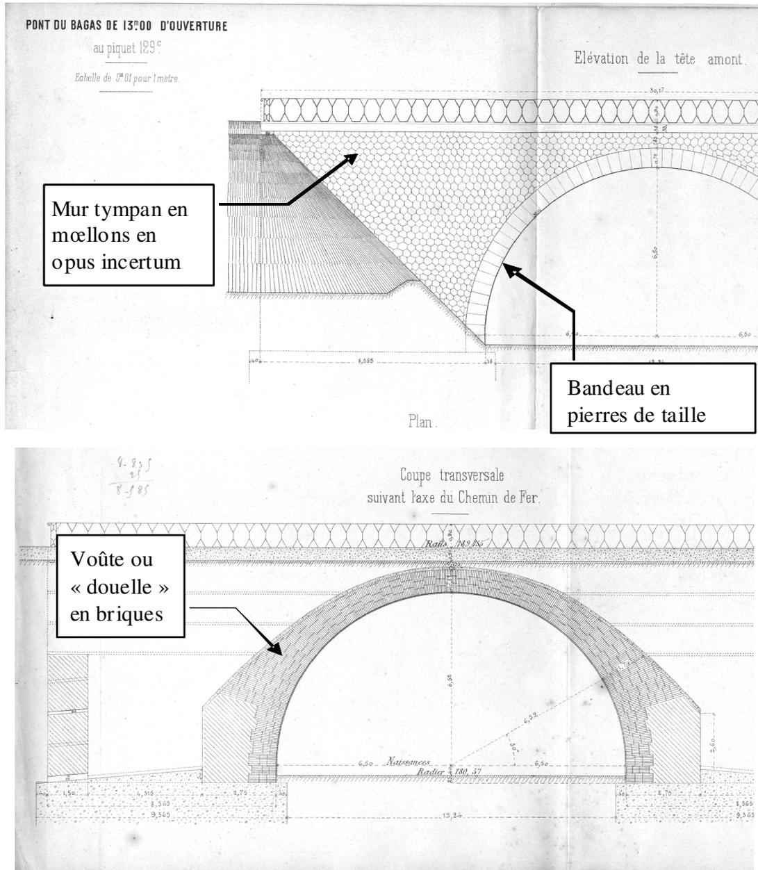
Figure 7. Répartition des matériaux. Exemple du pont du Bagas. Vues en élévation et coupe longitudinale. Le remplissage n'est pas représenté.
