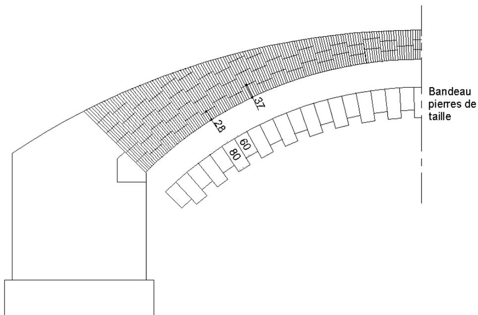
Figure 18. Appareillage des maçonneries de briques avec les bandeaux dans le cas des ponts de la ligne Castres-Albi, 1870. Exemple du pont la Millette.
