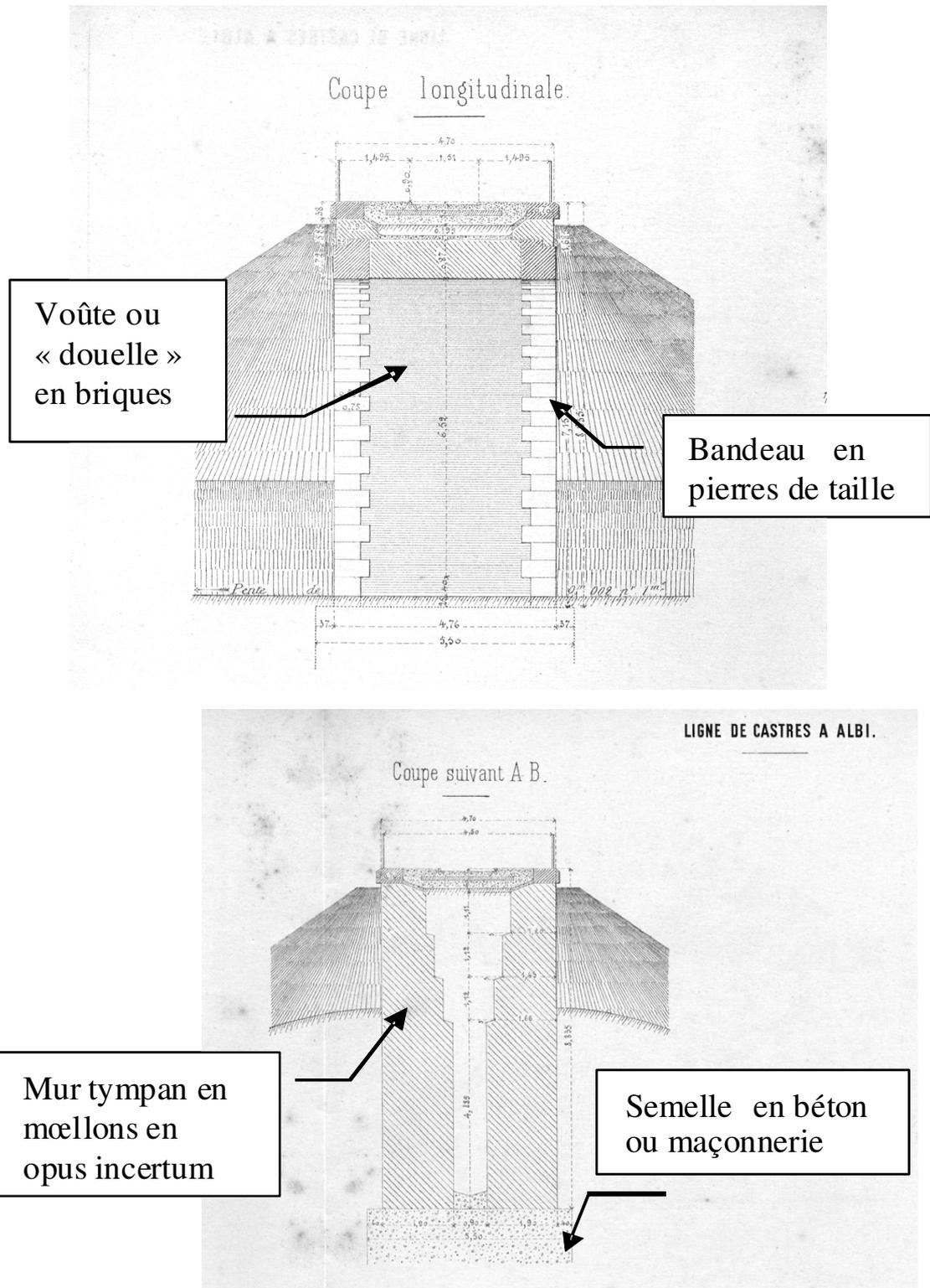
Figure 8. Répartition des matériaux. Exemple du pont du Bagas. Vues en coupes transversales. Noter l'épaisseur impressionnante des murs tympan, à la base.
