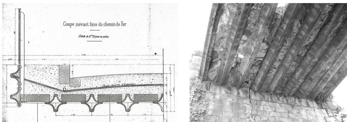
Figure 4. Tablier métallique à rail Barlow. A gauche : coupe suivant l'axe du chemin de fer.
